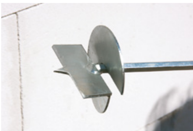
Na vytvoření kapsy použijeme plochý vrták.
