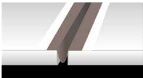
Umístění Mapebandu PE 120 ve tvaru omega smyčky do dilatační spáry
